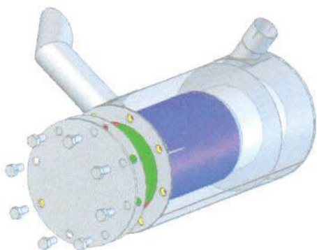
Figur 2: Lydpotte med boltet endedæksel
