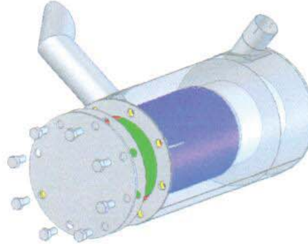
Figur 2: Lydpotte med boltet endedæksel
